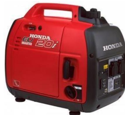
*Inverter é o sistema eletrónico que corrige as flutuações na corrente elétrica produzida pelo gerador, beneficiando o funcionamento dos equipamentos sensíveis, como computadores, radiotransmissores e iluminações para filmagens. Há também a possibilidade de conectar dois geradores em paralelo e duplicar a potência de saída sem alterar a voltagem normal.*
